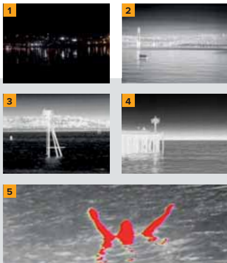
(1) Twój widok (2) Obraz z kamery Flir (3) Wyświetlanie znaków nawigacyjnych (4) Wykrywanie moła lub boi (5) Wykrywanie człowieka za burtą
